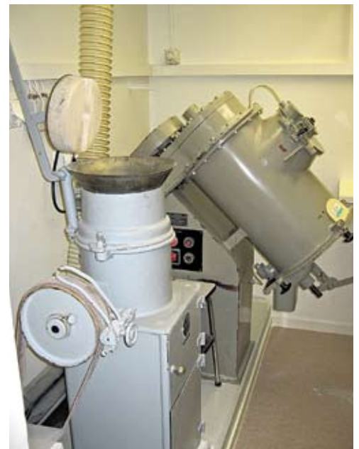
Die beiden Maschinen dienen der hauseigenen Herstellung der Schüssler-Salze.
